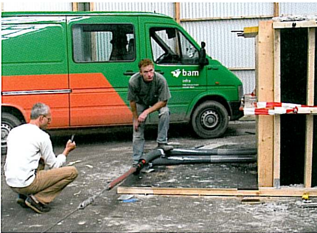
Bild 10: Test von Kabelverlegung im eingegossenen Kabelkanal.
