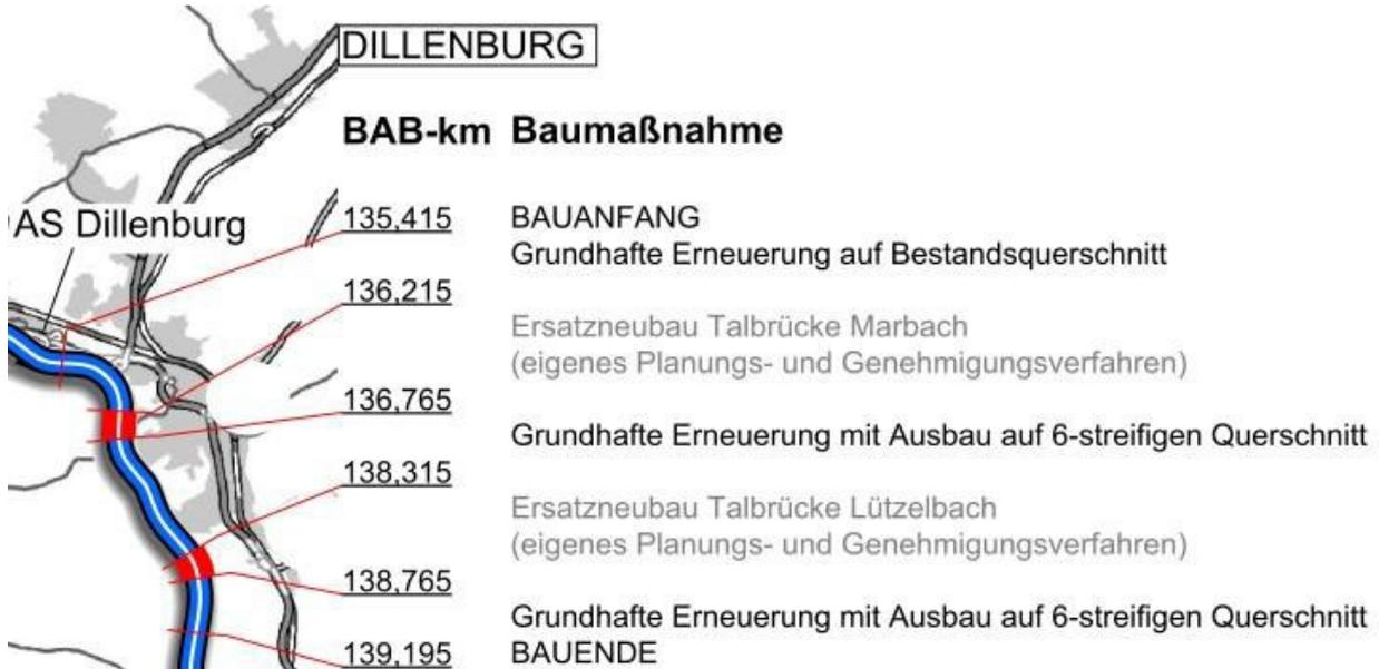
Abbildung 2 Übersicht Streckenabschnitte Baumaßnahme
