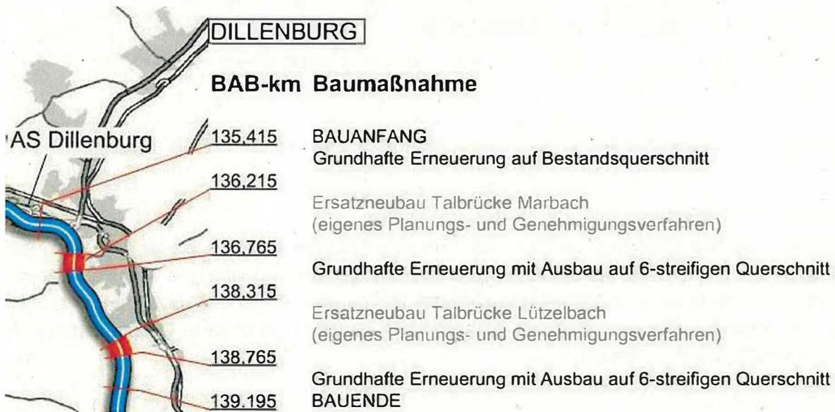
Abbildung 2 Übersicht Streckenabschnitte Baumaßnahme
