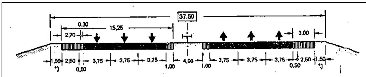
Abbildung 3 Vorhandener Streckenquerschnitt, Betriebs-km 135,415 bis 136,215
