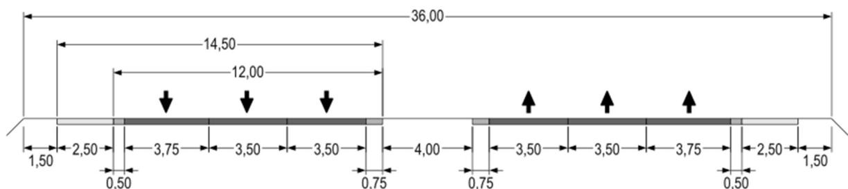
**Abbildung 5 Geplanter Streckenabschnitt, RQ 36**
