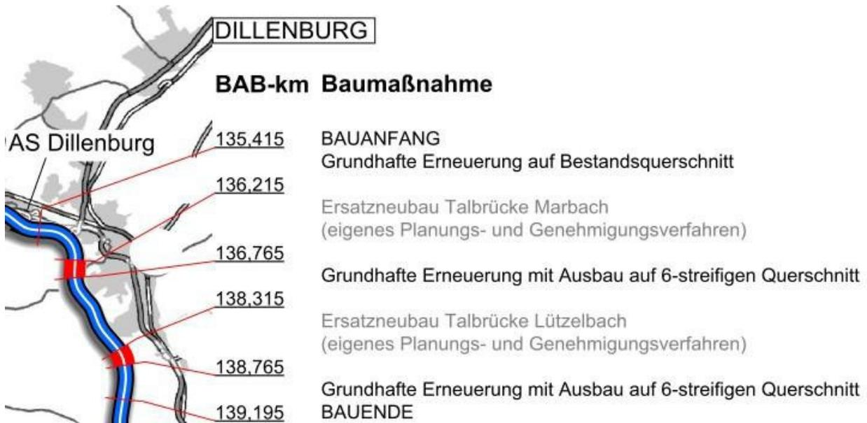
Abbildung 2 Übersicht Streckenabschnitte Baumaßnahme
