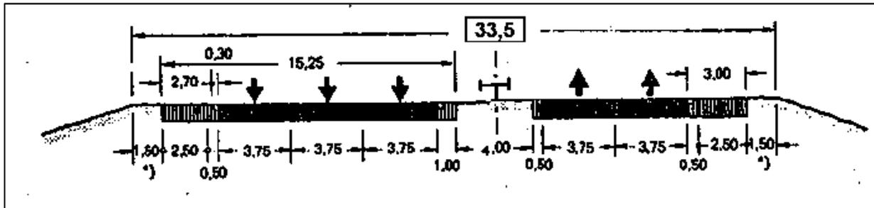
**Abbildung 4 Vorhandener Streckenquerschnitt, Betriebs-km 136,765 bis 139,195**
