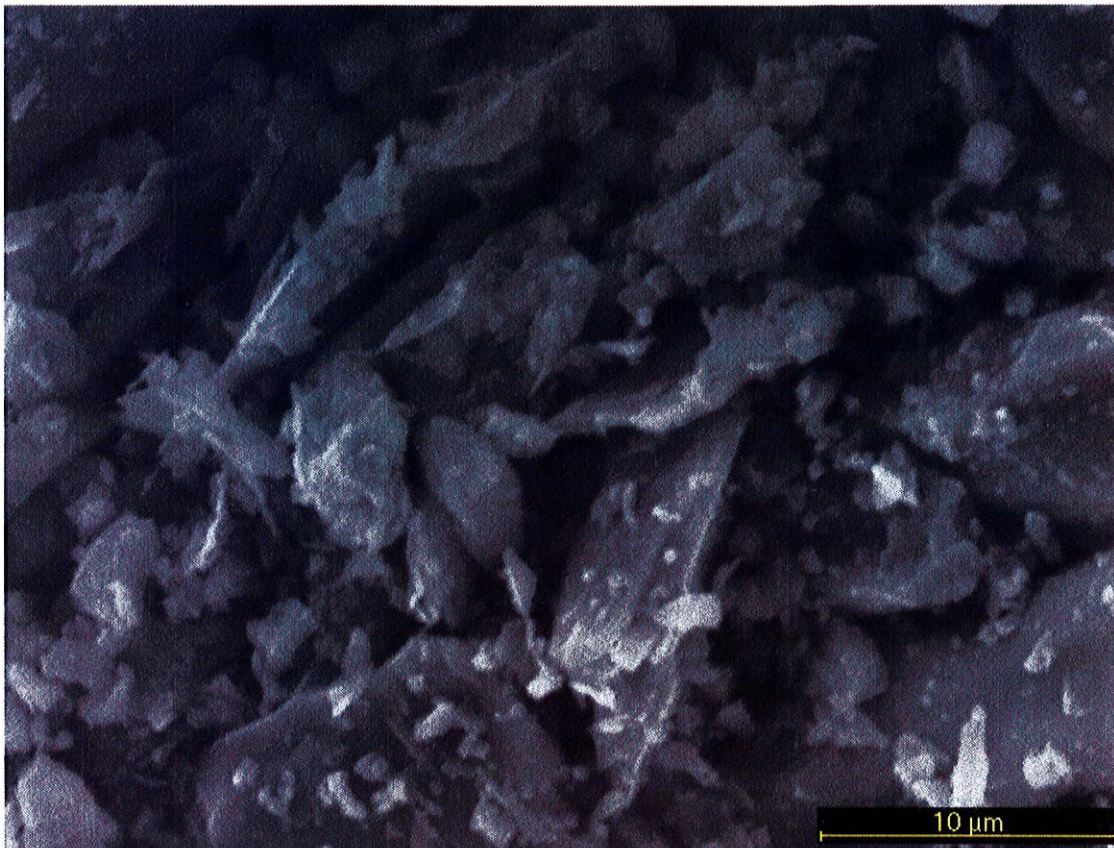
Bild 1 REM-Aufnahme der Probe Filterstaub Granodiorit &lt; 90 µm vom 08.08.2005
