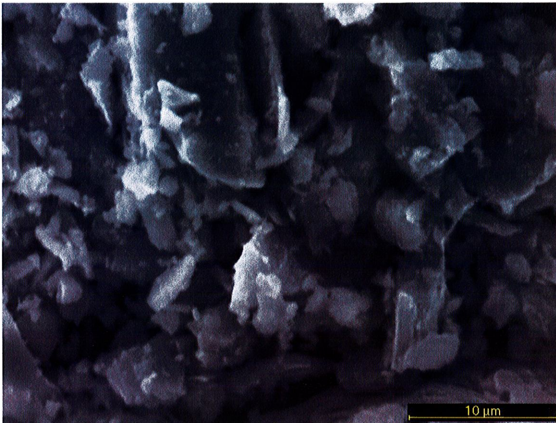
Bild 5 REM-Aufnahme der Probe Filterstaub Granodiorit &lt; 90 µm vom 08.09.2005
