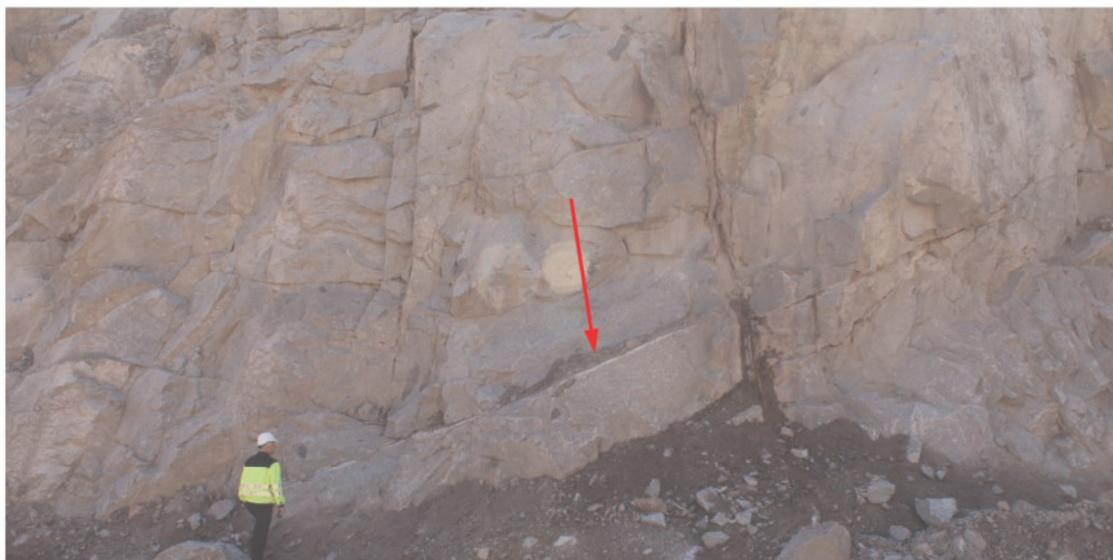
Bild 4.10: „Diagonalkluft“ in der Südwand
