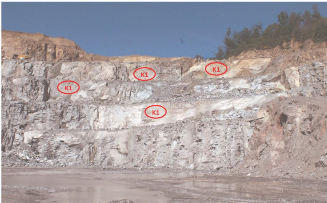
Bild 4.1: NW-Böschung des Steinbruchs mit der Trennflächenschar K1
