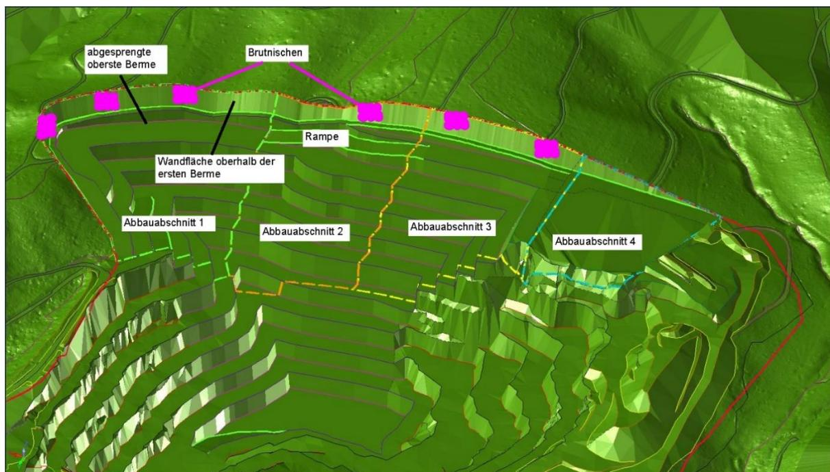
Abbildung 5: Darstellung der Abbauabschnitte und der Tagebauentwicklung sowie der Bereiche für die Anlage von Brutnischen (Ansicht der südlichen Erweiterung)
