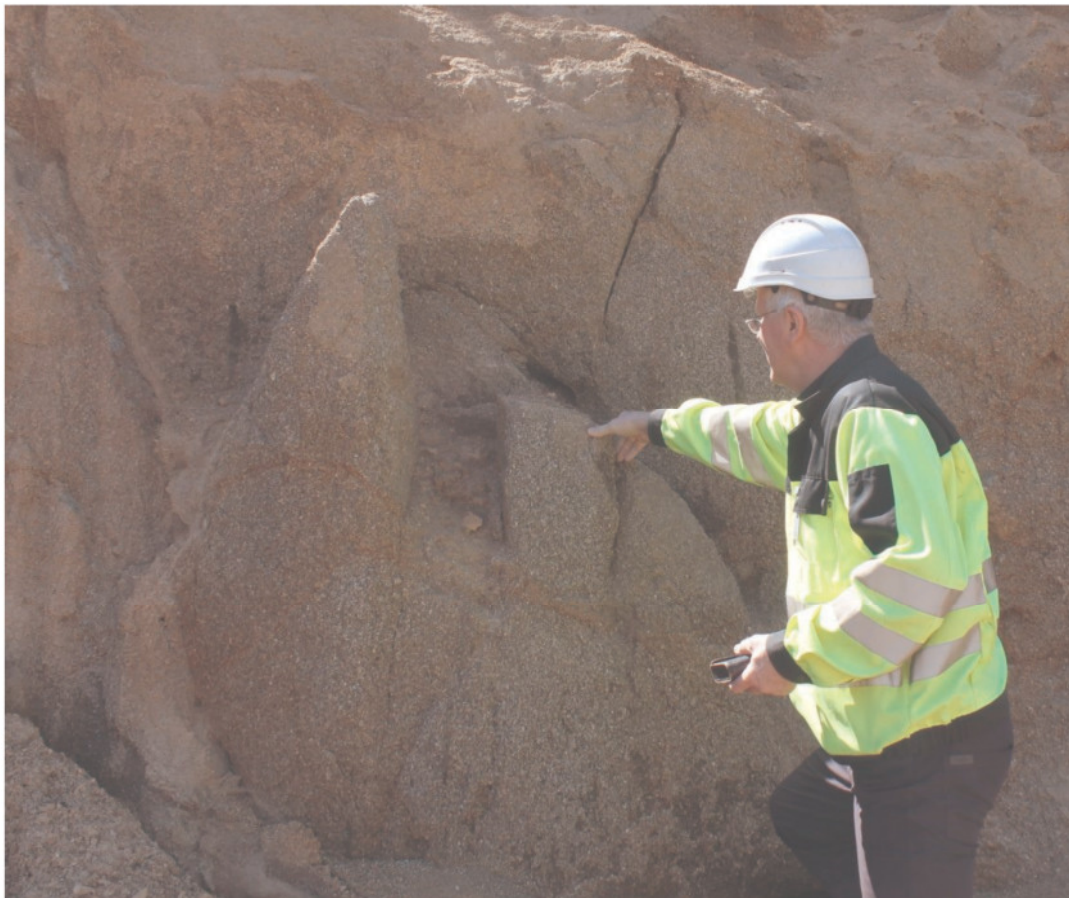
Bild 4.16: verwitterter Granodiorit in der Südwestecke
