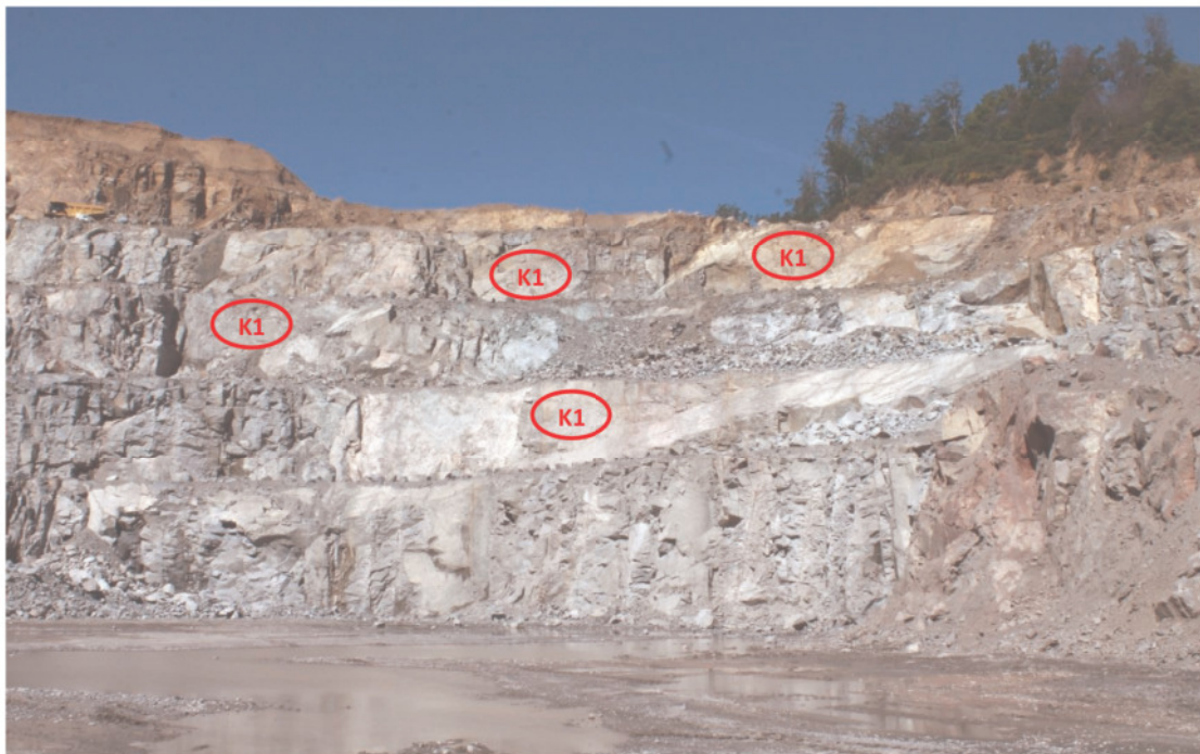
Bild 4.1: NW-Böschung des Steinbruchs mit der Trennflächenschar K1
