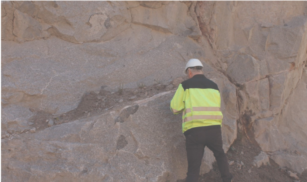
Bild 4.11: „Diagonalkluft“ in der Südwand
