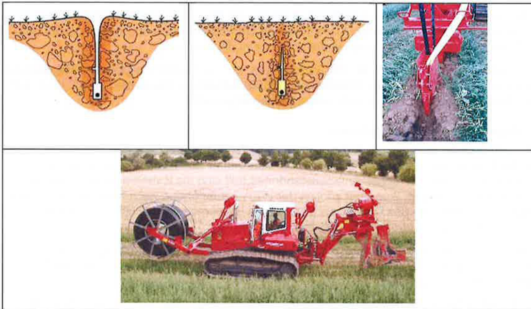
Abbildung 2: Prinzipskizze/Fotos Pflugverfahren (Fotos: Fa. Lancier Cable GmbH)
