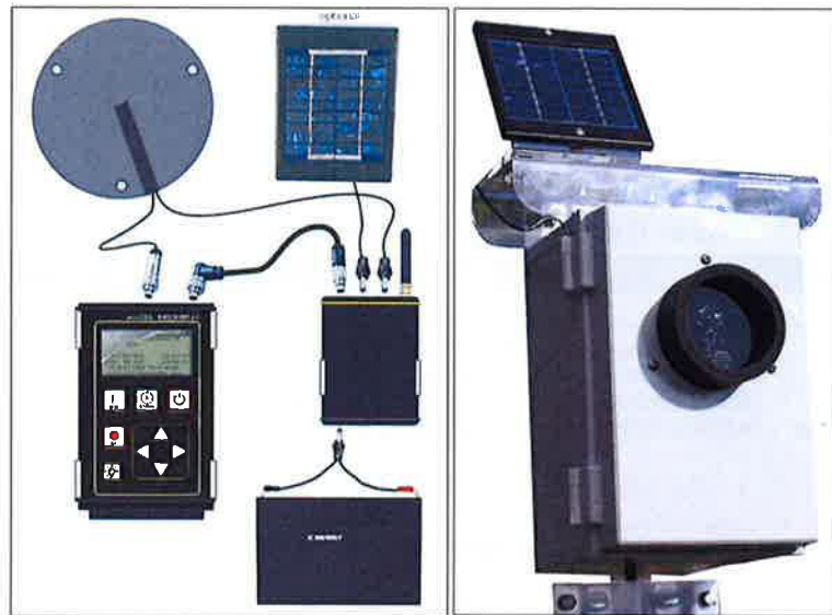
Abbildung 2.2: Außenansicht der Boxerweiterung mit Grenzflächenmikrofon und Solarpanel (links) und schematisierter Aufbau des verwendeten batcorder-Messsystems inkl. Box-Erweiterung (rechts) (Quelle: ecoObs GmbH)
