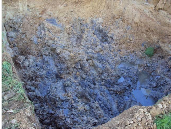
Durch Teeröl belasteter Boden unterhalb der Schwellen
