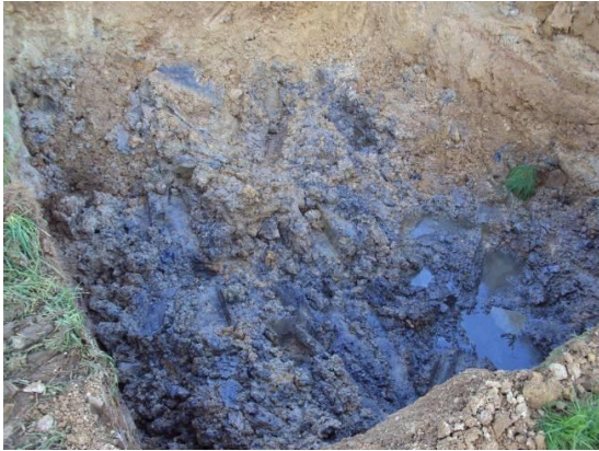
Durch Teeröl belasteter Boden unterhalb der Schwellen
