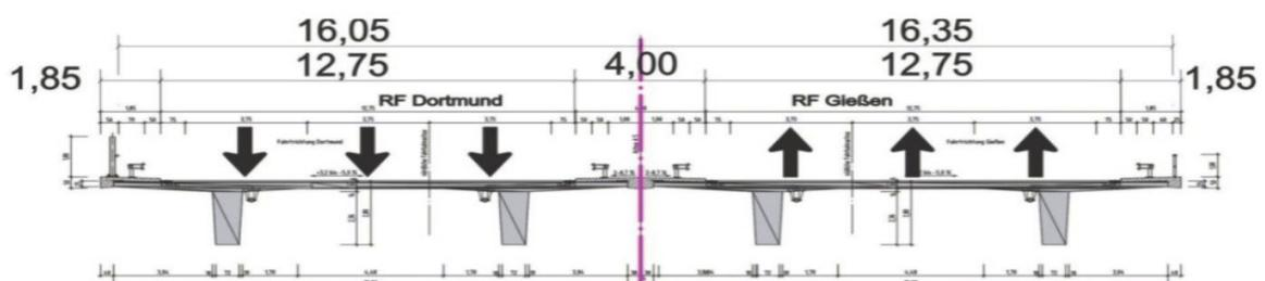
Abb. 2: Bestandsquerschnitt Talbrücke
