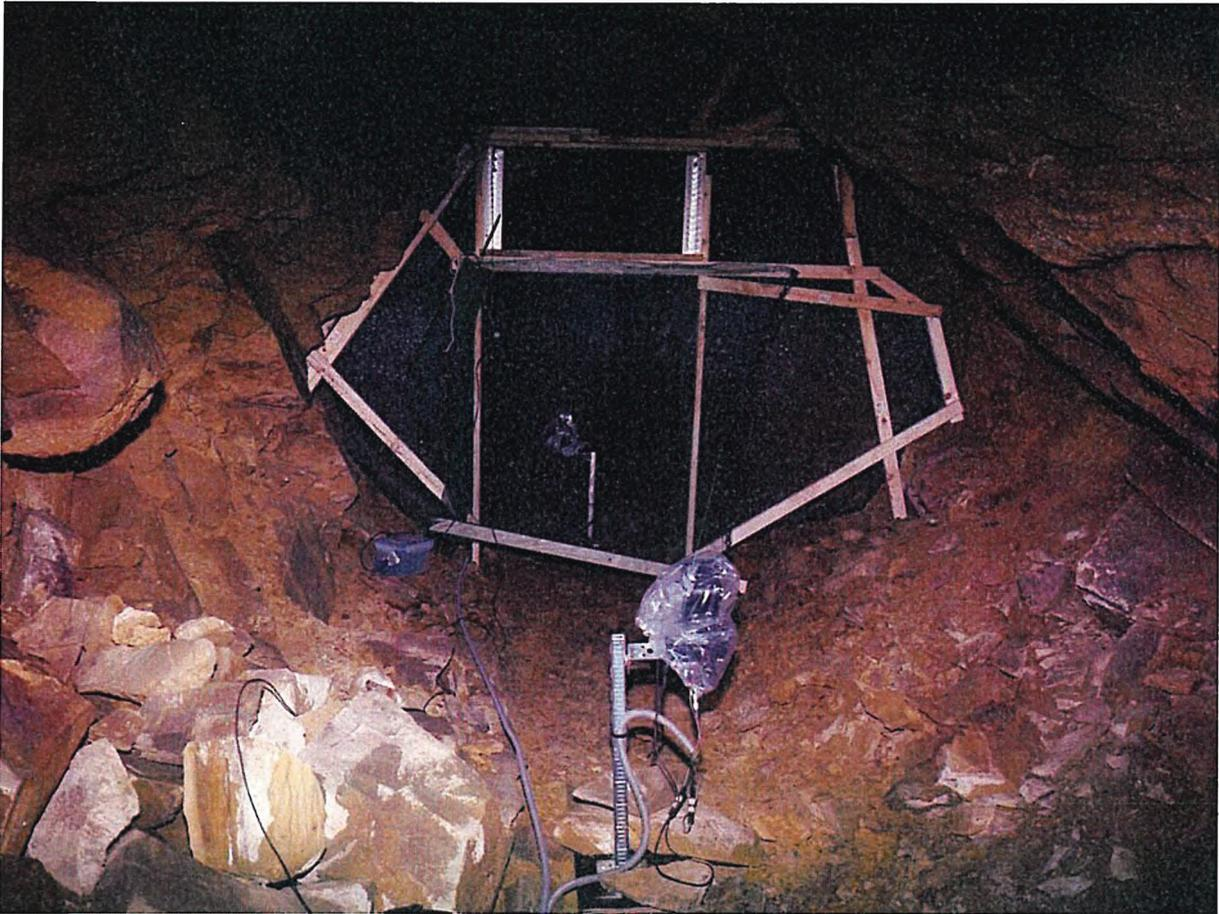
Abb. 3: Blick auf die am 1. März 2013 etwa 8 m vom Eingang entfernt installierte Binnenlichtschranke im Kalkabbaustollen. Im Vordergrund (nicht sichtbar) befinden sich die Batterien, in der Bildmitte die Ausflug- und im Hintergrund die Einflugkamera.
