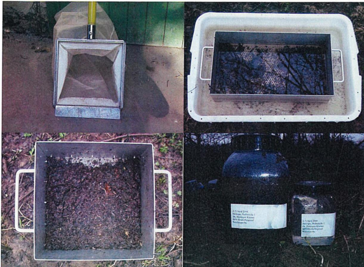
Abbildung 4: Probenaufarbeitung im Gelände: Benthoskescher (oben links), Abtrennen der organischen Grobfraktion mittels 0,5 cm-Sieb (oben rechts), Rückhalten der organischen Feinfraktion mittels 500 µm-Sieb (unten links), Aufbewahrung der Benthosprobe in PE-Weithalsbehältern (unten rechts).
