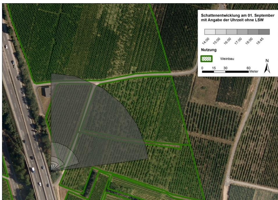
Abb. 9-2: Schattenentwicklung über den Weinanbauflächen Ende September unter Berücksichtigung der Brückenverbreiterung um 5 m. Der Zeitpunkt wurde als Darstellung gewählt, weil sich zu dieser Zeit die längsten Schatten bilden. Zu den anderen Zeitpunkten fällt der Schattenwurf geringer aus. (vgl. Tab. 9-3).
