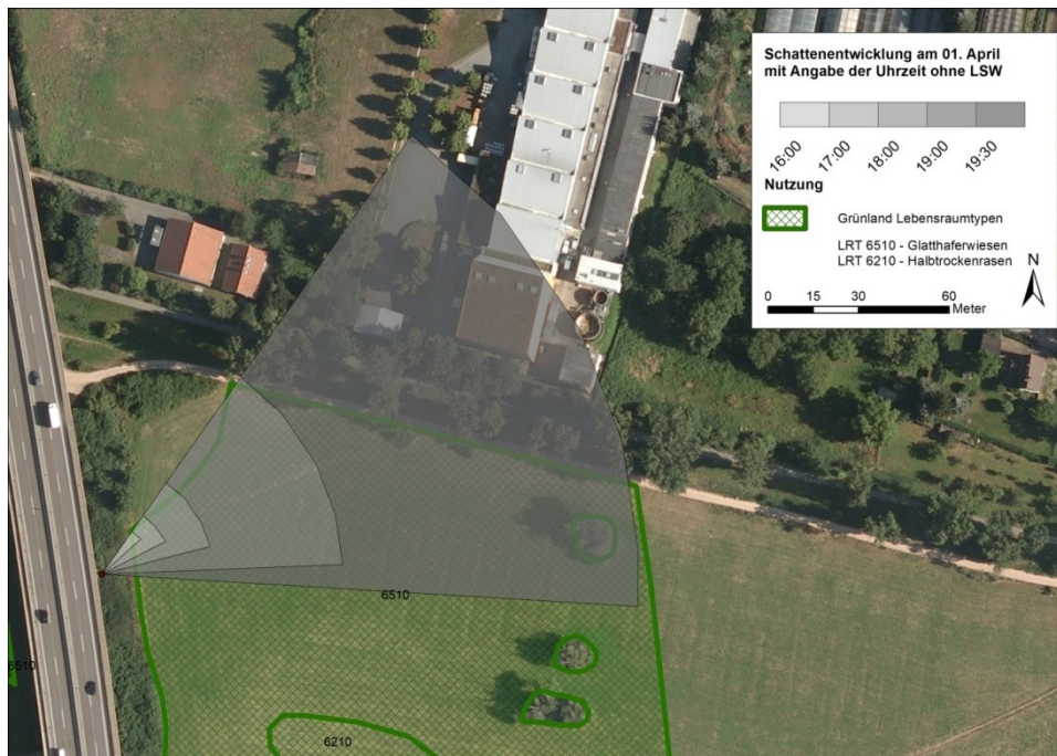
Abb. 9-1: Schattenentwicklung über den LRT-Flächen Anfang April unter Berücksichtigung der Brückenverbreiterung um 5 m. Der Zeitpunkt wurde als Darstellung gewählt, weil sich zu dieser Zeit die längsten Schatten bilden. Zu den anderen Zeitpunkten fällt der Schattenwurf geringer aus (vgl. Tab. 9-2).
