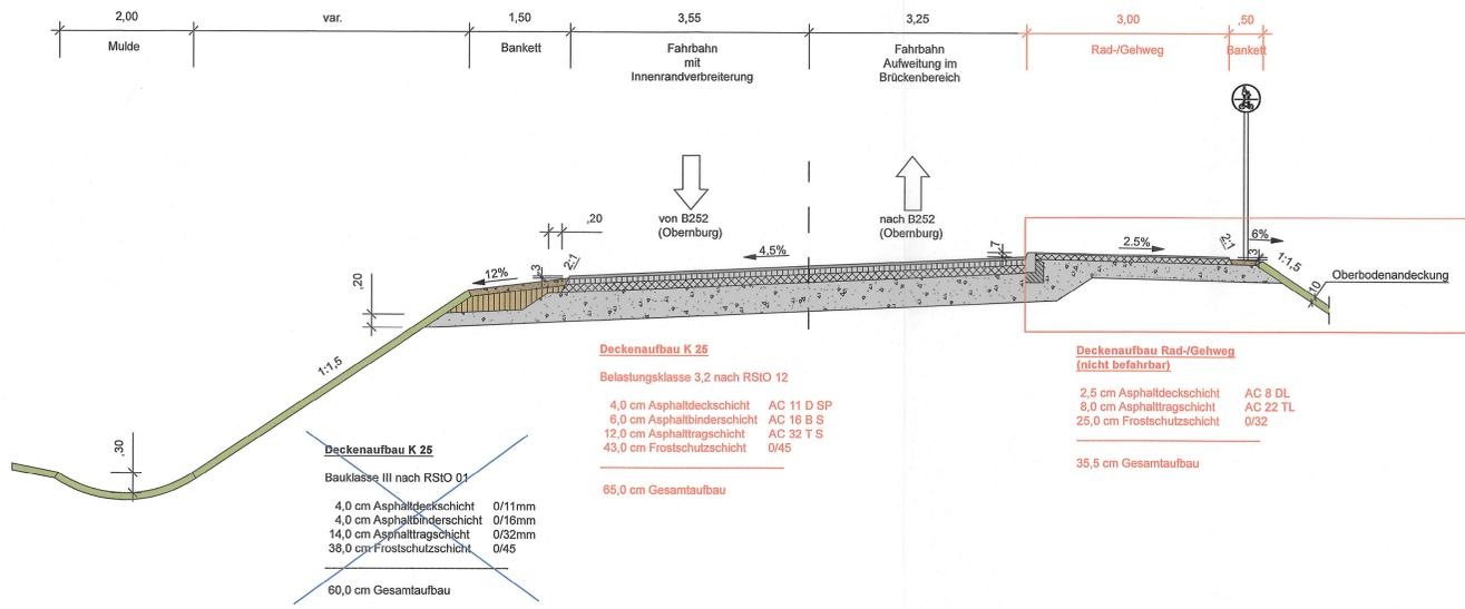
**Deckenaufbau K 25**
