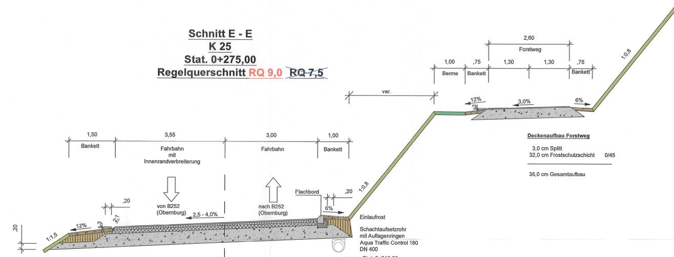
**Deckenaufbau K 25**
