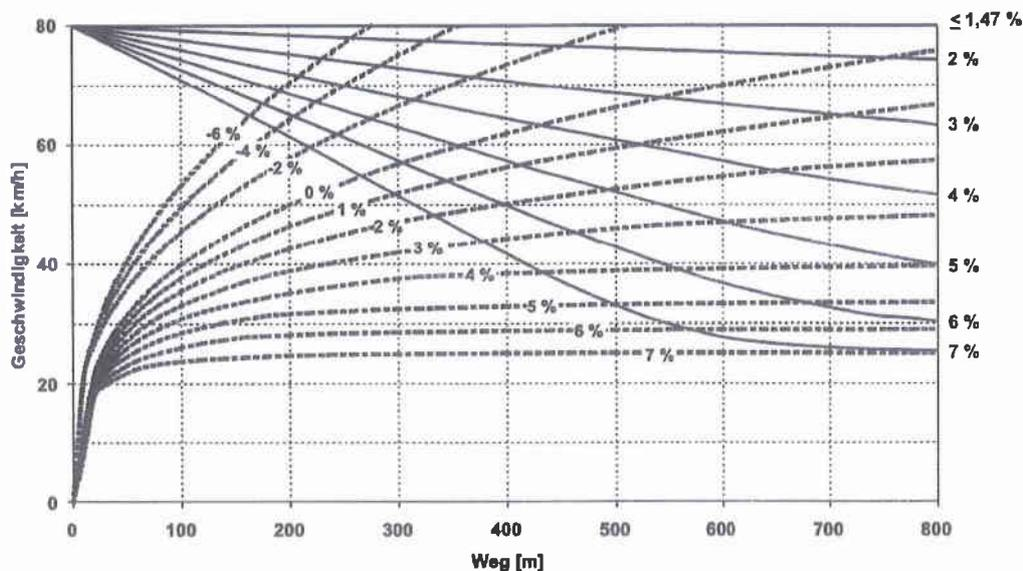
Bild 2: Geschwindigkeitsprofile für Schwerfahrzeuge in Abhängigkeit der Längsneigung (Schlussbericht)
