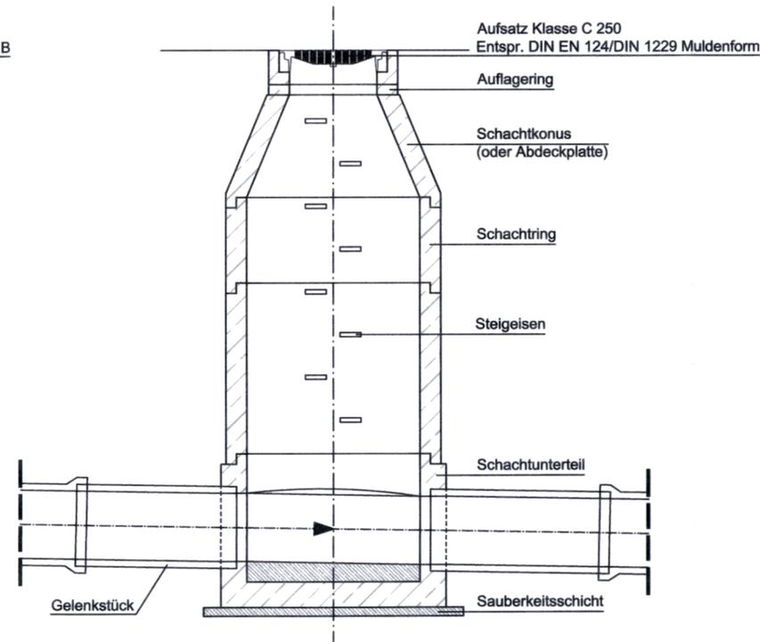
Schnitt Regelschacht DIN 4034
