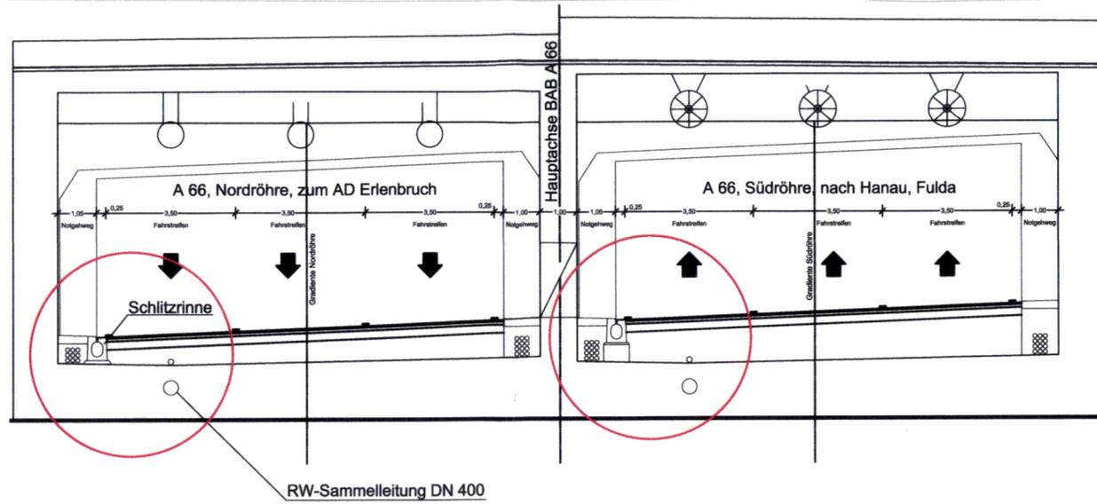
**Detail Schachtanschluss Tunnelentwässerung
