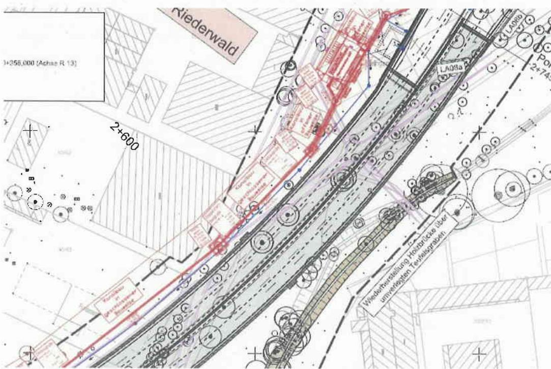
Abbildung 7: DN 600 östlicher Abschnitt mit Anschluss an RRB 4
