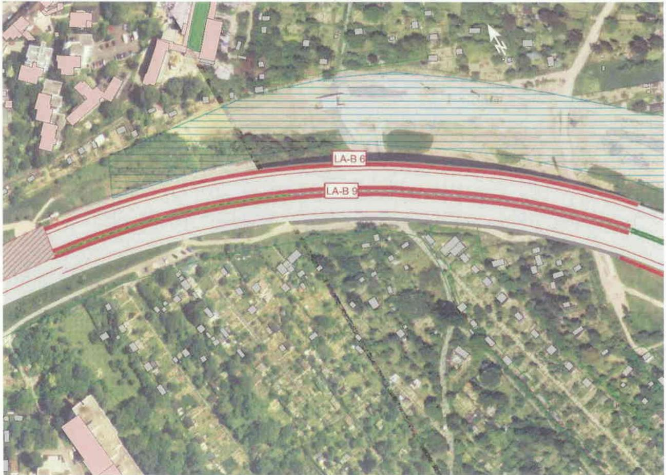
Abbildung 8 Geplante Lärmschutzwand im Mittelstreifen der A 661 [2]
