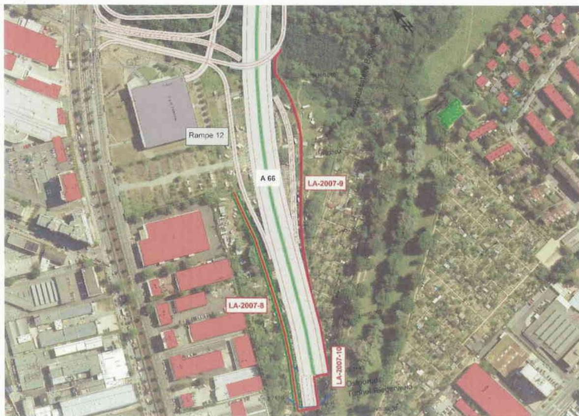
Abbildung 10 Planfestgestellte Lärmschutzmaßnahmen im Bereich des Ostportals und der AS Borsigallee [2]
