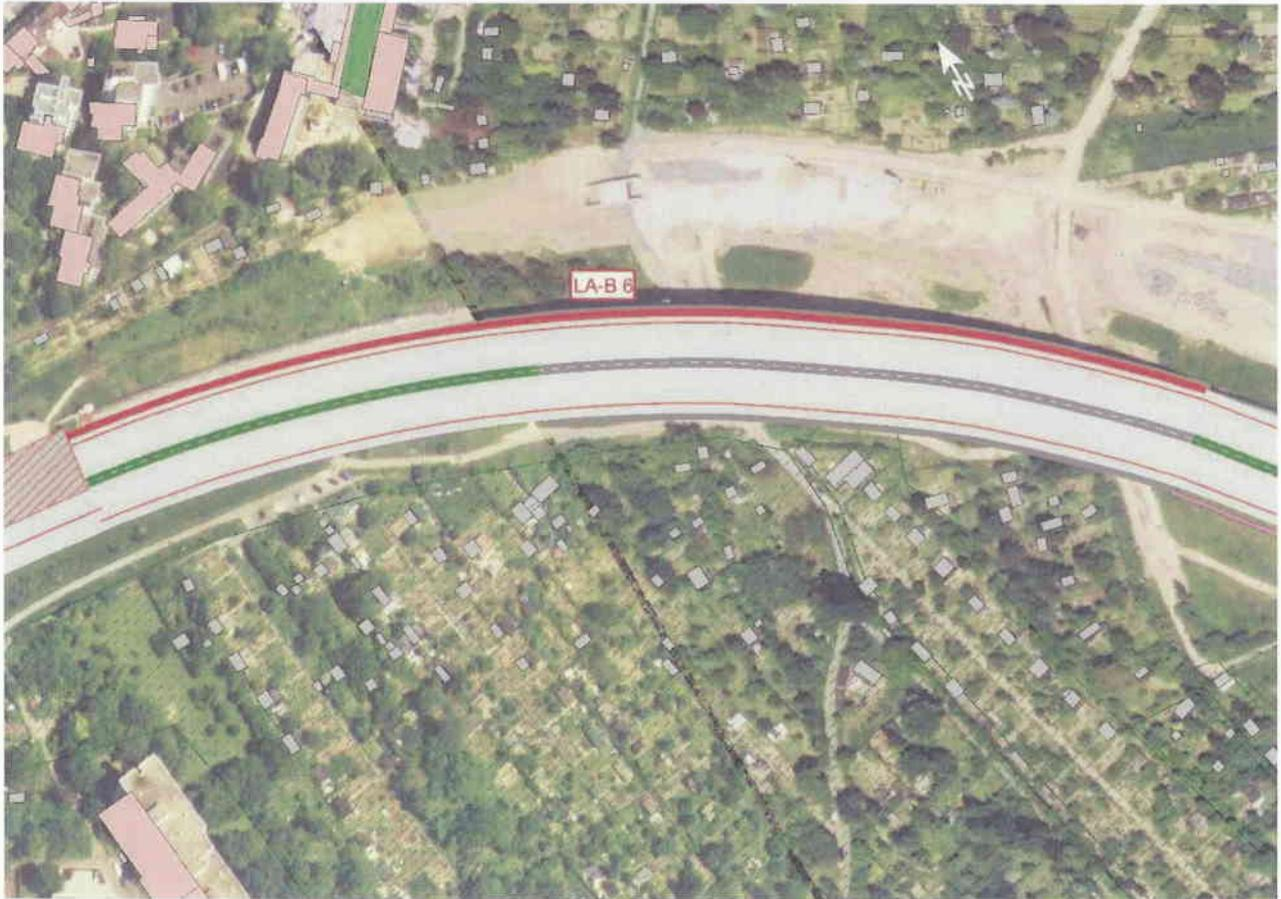
Abbildung 6 Lärmschutzwand im Bereich Seckbach [2]
