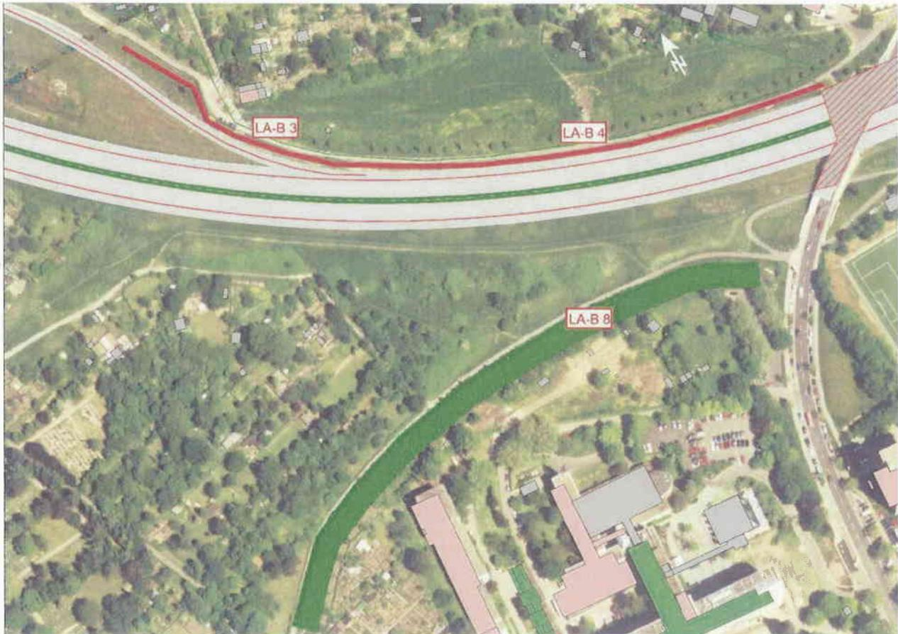
Abbildung 4 Übersicht der umgesetzten Lärmschutzmaßnahmen im Bereich "Katharinenkrankenhaus"[2]
