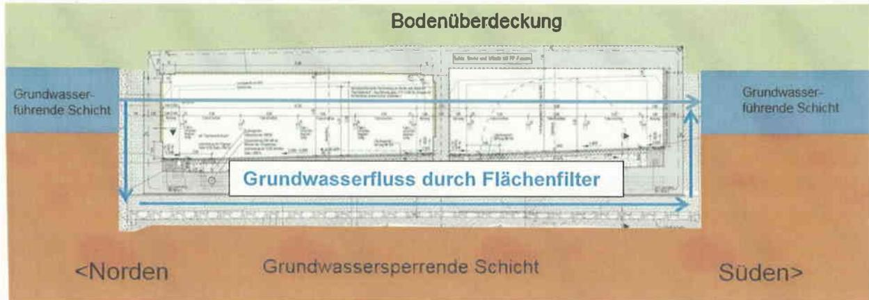
Bild 12: Prinzipskizze Funktion des umlaufenden Flächenfilters
