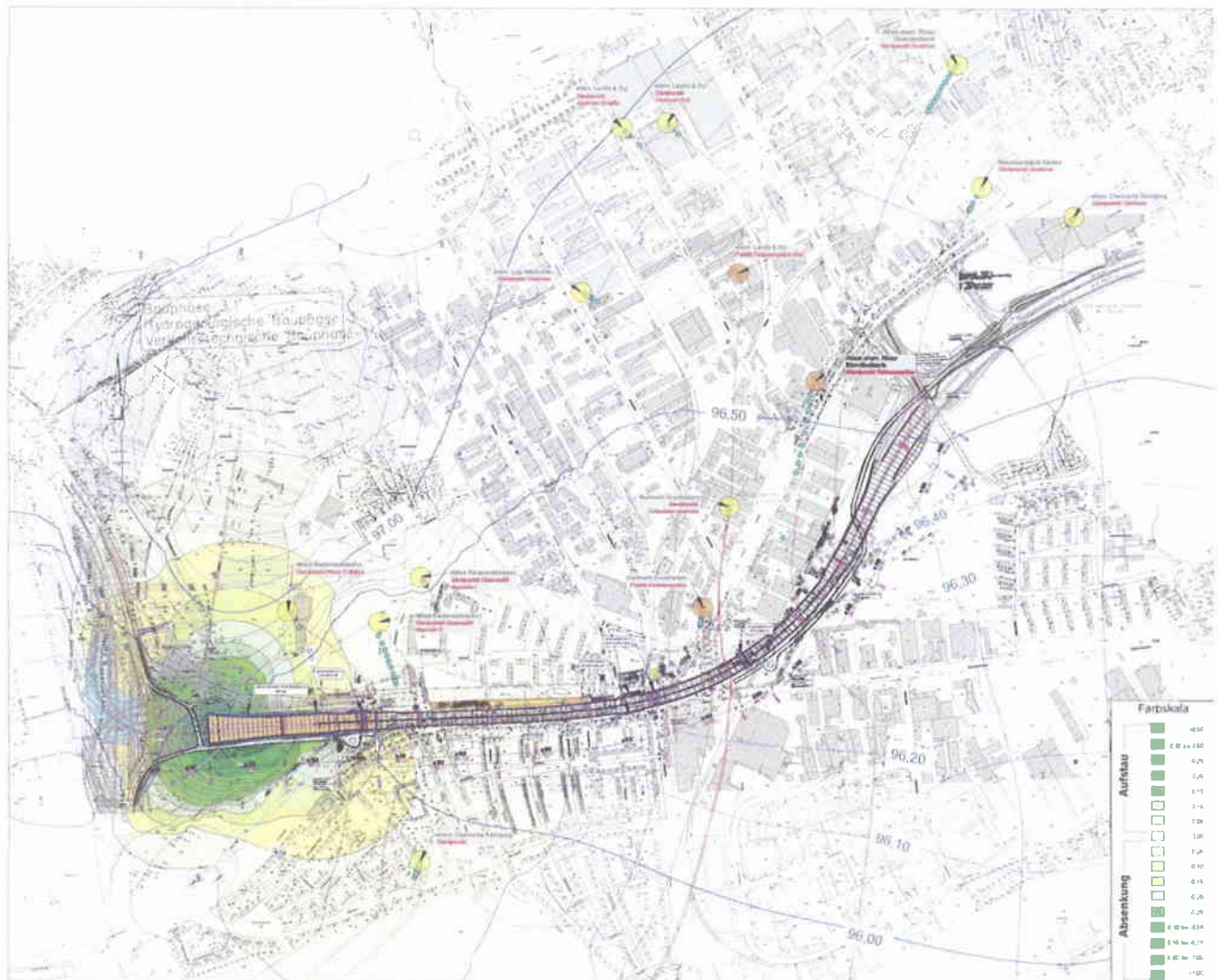
Abbildung 21: Hydrogeologische Bauphase 3, Gesamtdarstellung, GW-Gleichen, Differenzplan, Strömungslinien
