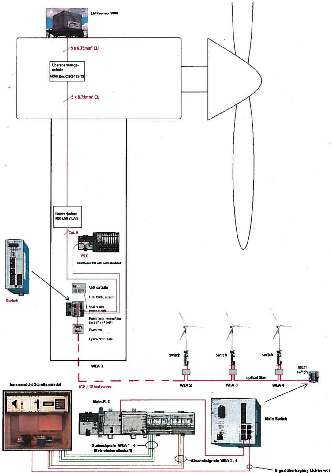
Abbildung 12-1: Prinzipskizze „Einbindung in die VestasOnline™ Fernüberwachung“
