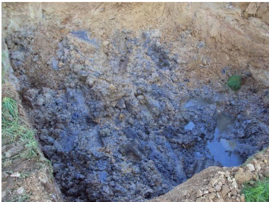
Durch Teeröl belasteter Boden unterhalb der Schwellen
