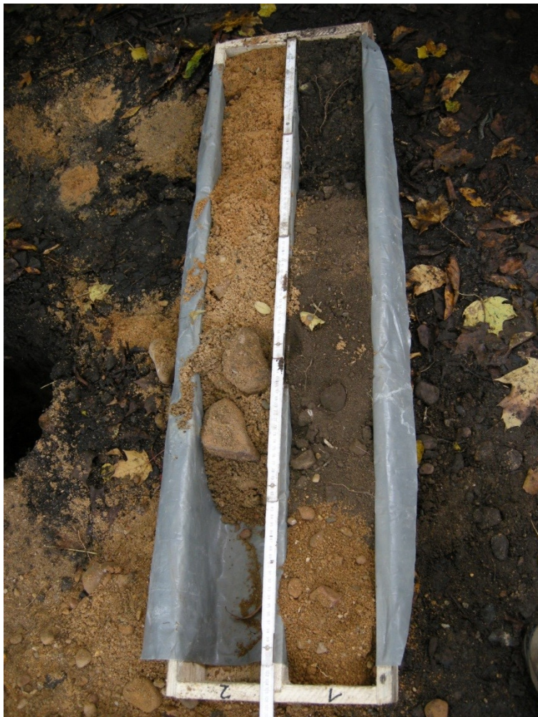
Abb. 6 Kernkiste Bohransatzpunkt 5 (- 0,8 m Auffüllungen, > 0,8 m C n )
