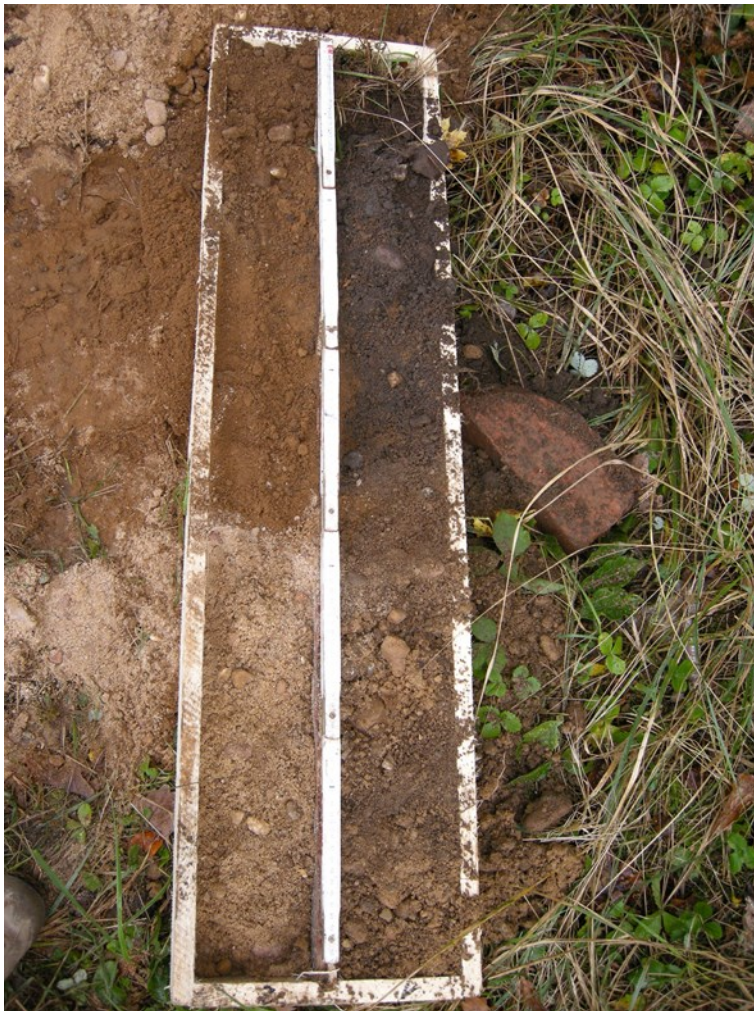
Abb. 8 Kernkiste Bohransatzpunkt 7 (- 1,5 m Auffüllungen, > 1,5 m C n )
