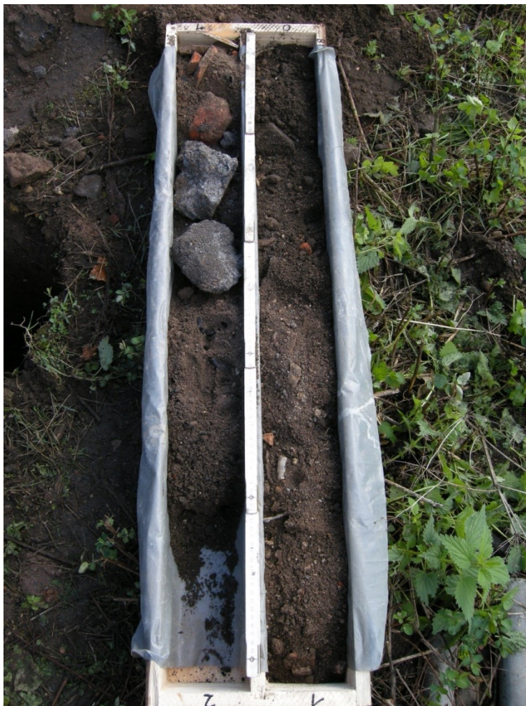
Abb. 5 Kernkiste Bohransatzpunkt 4 (Auffüllungen bis 1,8 m Tiefe)
