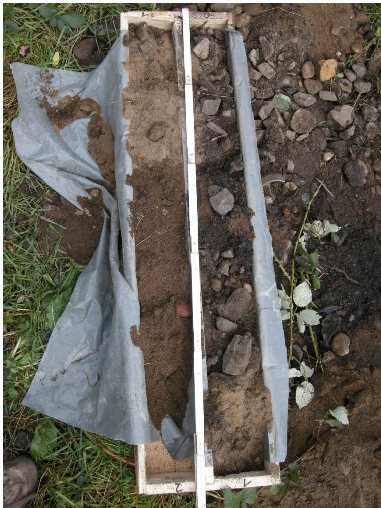
Abb. 4 Kernkiste Bohransatzpunkt 3 (Auffüllungen bis 1,8 m Tiefe)
