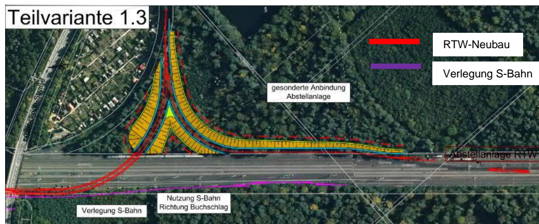
Abbildung 18: VU 20/22 - Teilvariante 1.3 – 2. Westvariante nach Dreieich-Buchschlag mit Anschluss an die Variante 1 der VU 19 (Quelle: Vorplanung RTW, 2011)
