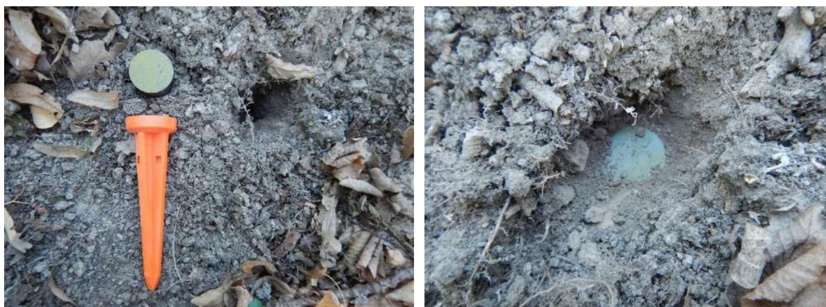
Abbildung 1 und Abbildung 2: Vermarkung der Aufnahmeflächen mit Rundblockdauer-magneten und dazugehörigem Plastikkegel vor und nach dem Versenken in den Boden.
