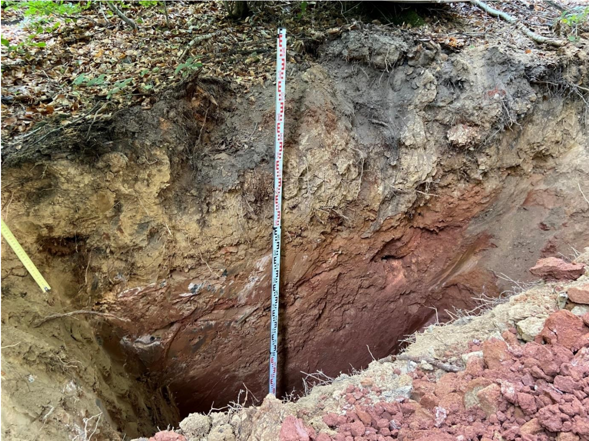
Abbildung 14: Braunerde in Schurf 14. Die rötliche Farbe des Untergrunds ist durch den Buntsandstein bedingt.
