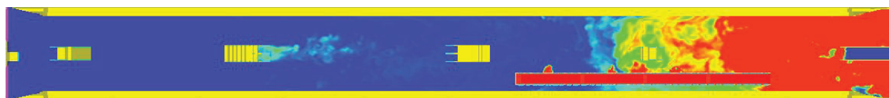
Bild 31: Verteilung der Optischen Dichte im Querschnitt nach 20,0 Minuten Brand; Szenario 1B (rot: „verrauchter Bereich“)
