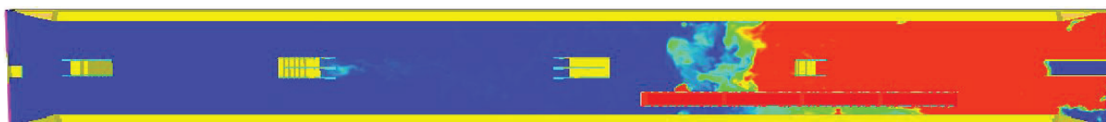
Bild 32: Verteilung der Optischen Dichte im Querschnitt nach 20,0 Minuten Brand; Szenario 3B (rot: „verrauchter Bereich“)
