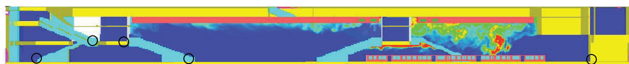
Bild 16: Verteilung der Optischen Dichte im Querschnitt nach 10,0 Minuten Brand; Szenario 3B (rot: „verrauchter Bereich“)
