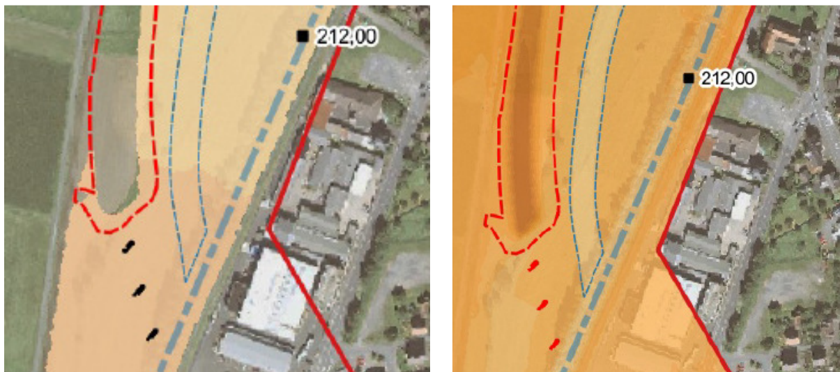
Abbildung 13: Wasserspiegellagen (links) und Geländehöhen (rechts) am Brückenbauwerk 3.
