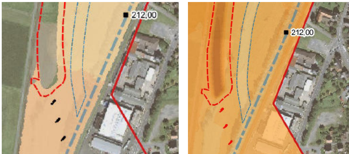
Abbildung 13: Wasserspiegellagen (links) und Geländehöhen (rechts) am Brückenbauwerk 3.
