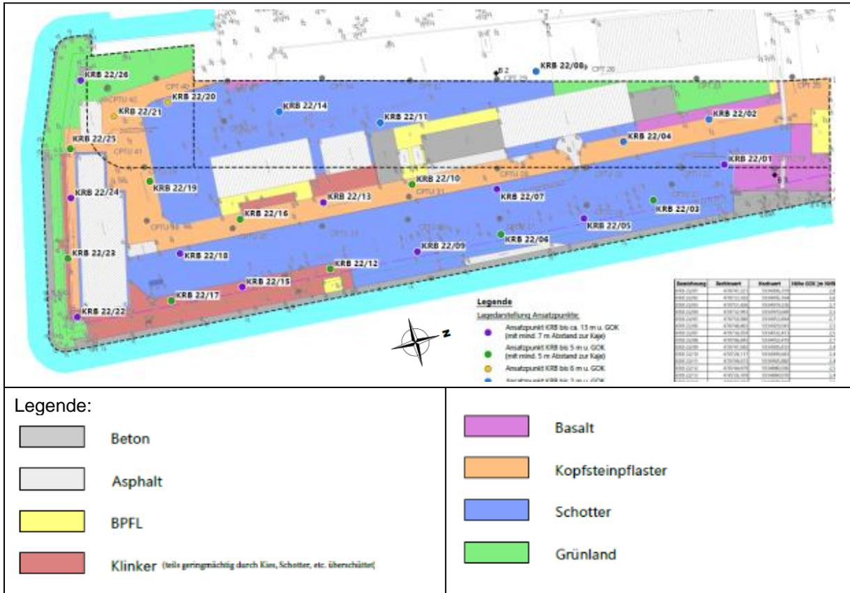
**Abbildung 3: Oberflächenbefestigung innerhalb des Projektgebietes**
