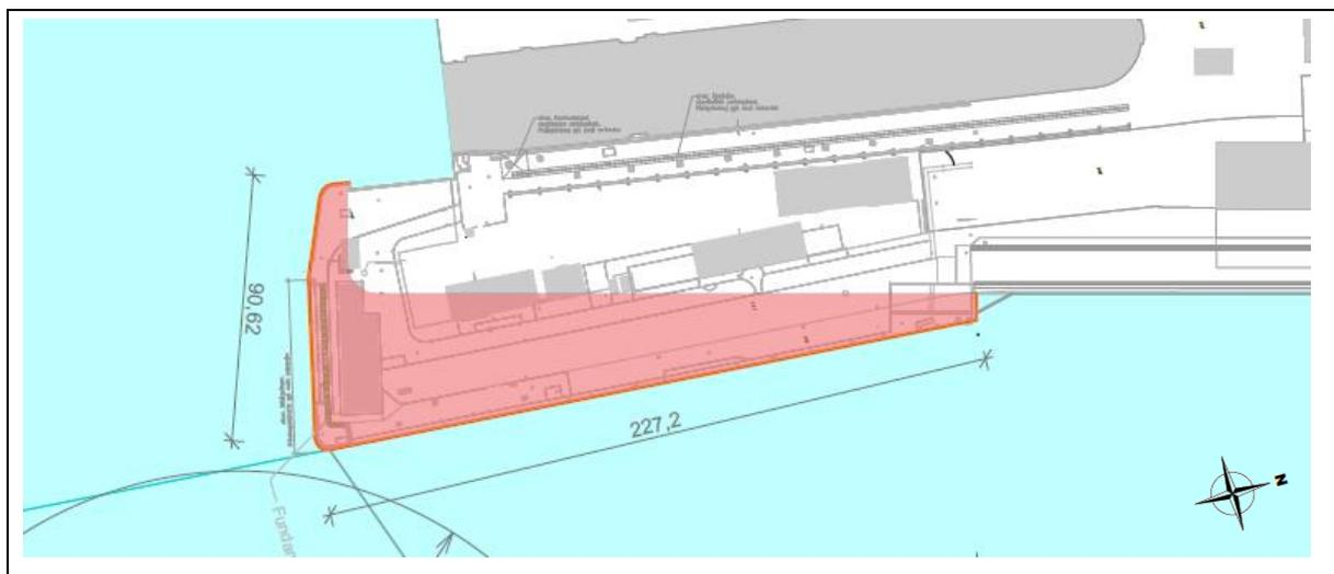
**Abbildung 8: Rückbau der Bestandskaje bis zur Hafensohle (rot hinterlegt)**
