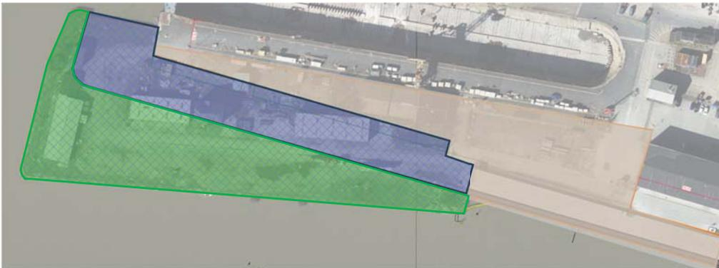
Abbildung 4: Darstellung der Teilflächen „Aushub auf Niveau Hafensohle“ (grüne Fläche) und „Bodenaustausch/Herstellung Oberflächenbefestigung“ (blaue Fläche). Ausschnitt aus der Planunterlage „Lageplan Baustellenfläche 2.9“ durch bremenports zur Verfügung gestellt.
