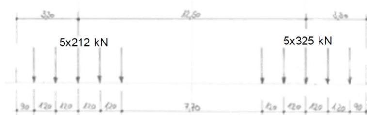
Lastfall C für die wasserseitige Kranschiene (Auslegerstellung quer zur Pier)
