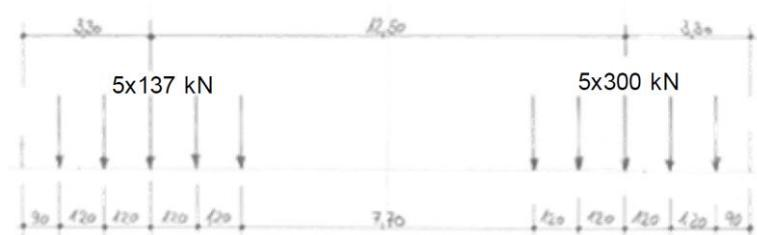
Der Lastfall „außer Betrieb“ wird (auch für die Landseitige Kranschiene) nicht maßgebend, da die Lasten ohne einen Schwingbeiwert nachzuweisen sind.
