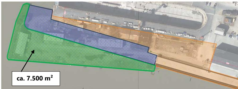
Abbildung 2: Darstellung der Teilflächen „Aushub auf Niveau Hafensohle“ (grüne Fläche) und „Bodenaustausch/Herstellung Oberflächenbefestigung“ (blaue Fläche). Ausschnitt aus der Planunterlage „Lageplan Baustellenfläche 2.9“ durch bremenports zur Verfügung gestellt.
