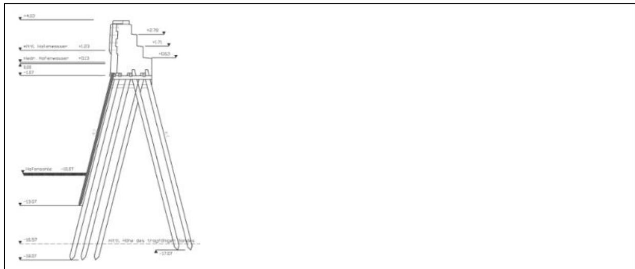
**Abbildung 8: Systemdarstellung Schwergewichtsmauer**
