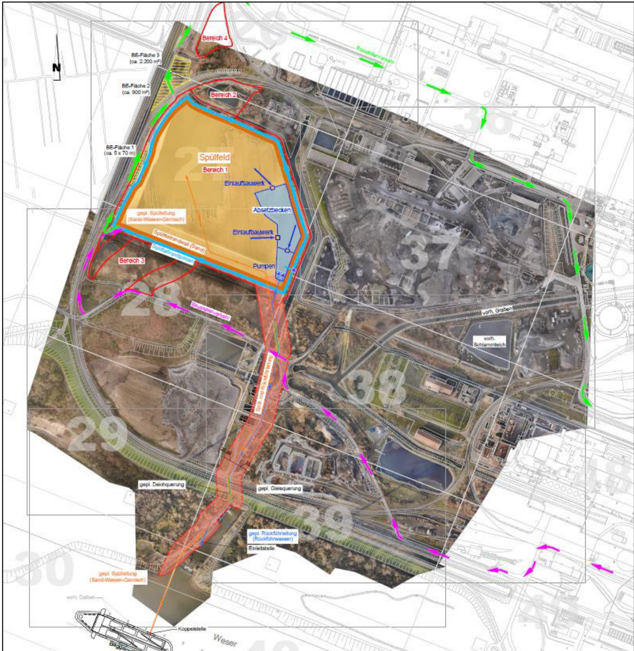
Abbildung 2.3-1: Baustelleneinrichtungsplan Ausführungsweise 2 Einspülen von Sand (Quelle IGB)
