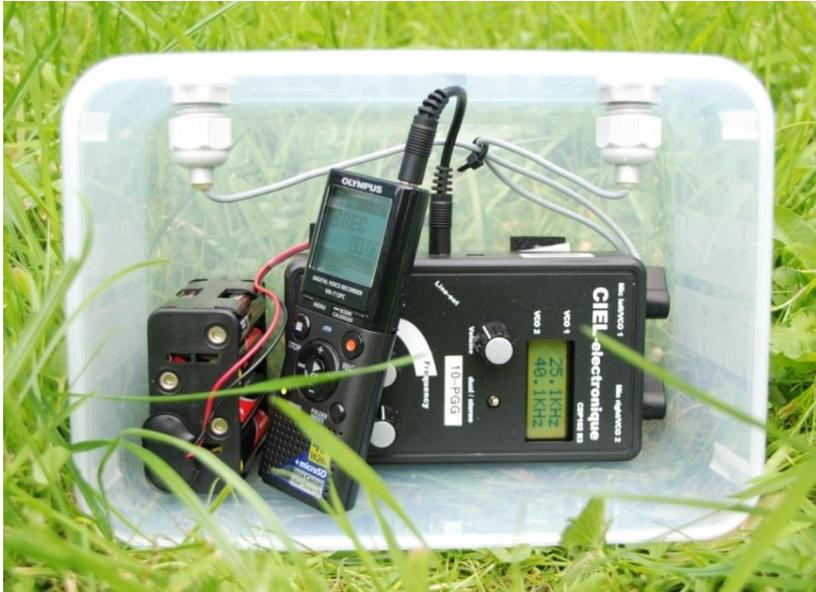
Abbildung 6: Beispiel für den Aufbau einer Horchkiste
