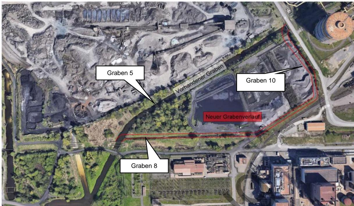
**Abbildung 1:** Vorhandener und geplanter Grabenverlauf (Quelle: Inros-Lackner GmbH)
