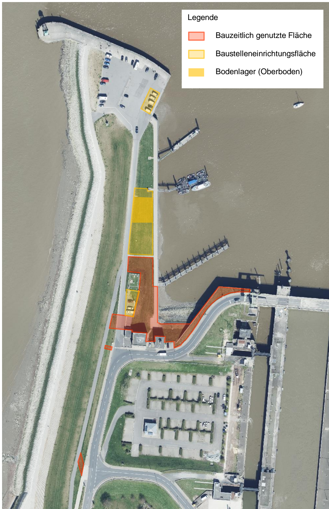
Abb. 10: Bauzeitlich genutzte Flächen und BE-Flächen (inkl. Bodenlager)
