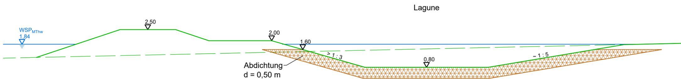
Der Bodenaufbau wurde auf Grundlage der zur Verfügung gestellten Unterlagen abgeschätzt.
