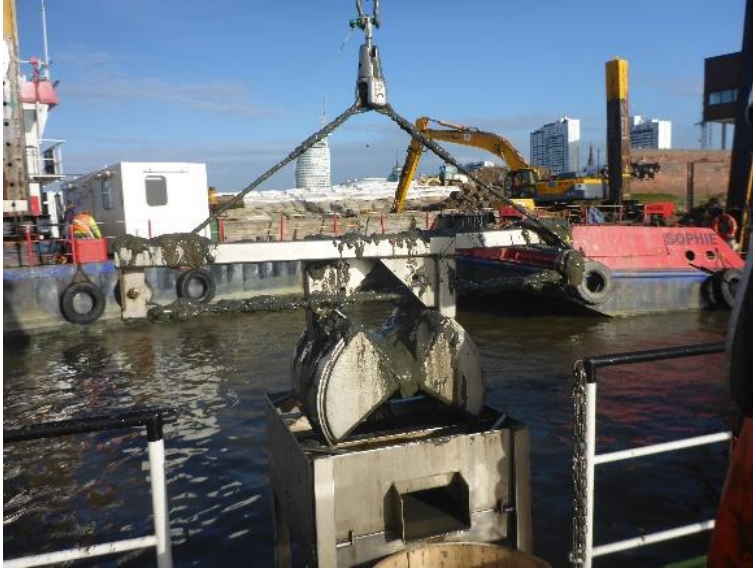
Abb. 3: Van-Veen-Greifer (0,1 m 2 Fläche) für die Erfassung der Infauna.
