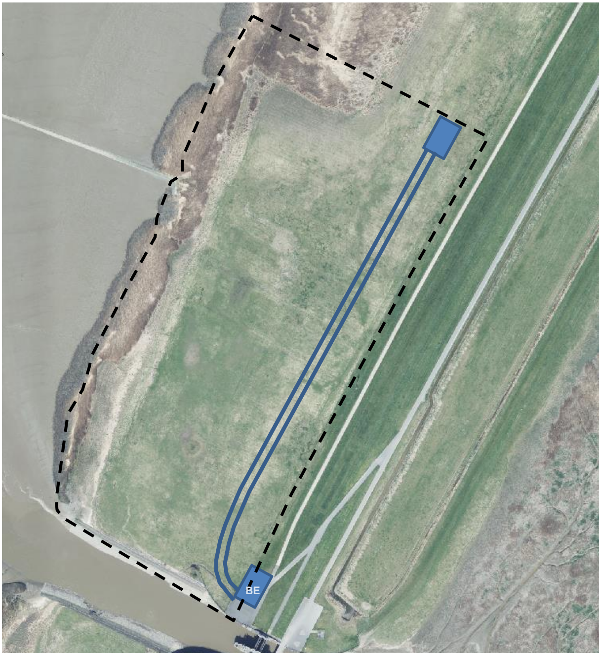
Abb. 8: Baustraße und Baustelleneinrichtung im Baubereich (Quelle: https://hafengis.bremenports.de/ )
