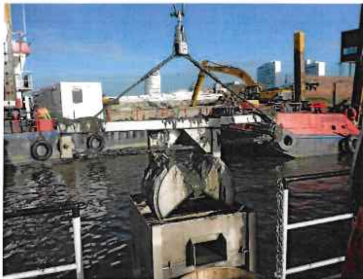
Abb. 3: Van-Veen-Greifer (0,1 m 2 Fläche) für die Erfassung der Infauna.
