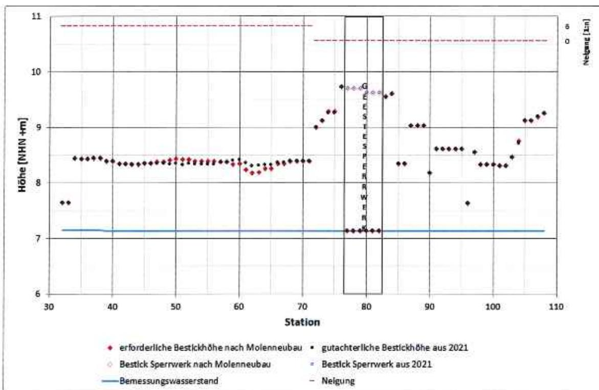
**Abb. 2:** Rechnerische Bestickhöhe im Bereich der Geestemündung mit dem Sperrwerk als wasserstandskehrendes Bauwerk der neuen Variante (rote Rauten) und der gutachterlichen Bestickhöhen aus 2021 (blaue Punkte), sowie die Bestickhöhen für das Sperrwerk als sturmflutkehrendes Bauwerk (rote Hohlrauten beziehungsweise blaue Hohlkreise). Die Stationsnummerierung entspricht der aus Abbildung 1.
