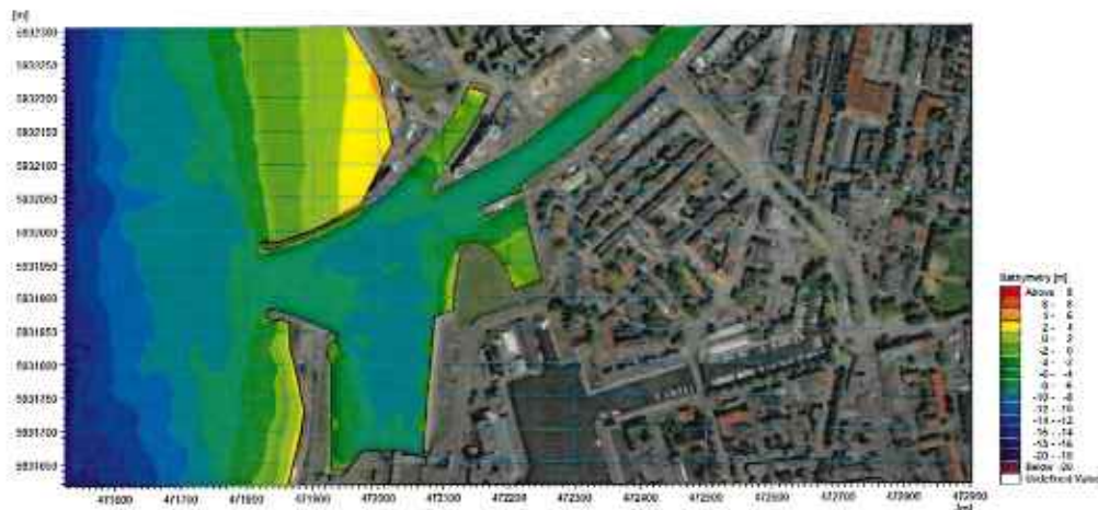
Abbildung 4: Bathymetrie des Istzustandes in mNHN
