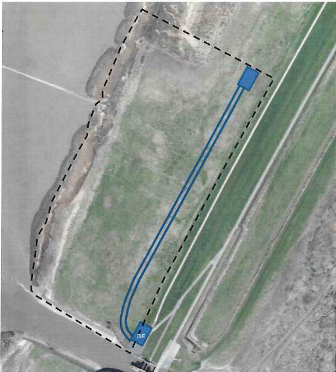
Abb. 8: Baustraße und Baustelleneinrichtung im Baubereich (Quelle: https://hafengis.bremenports.de/ )
