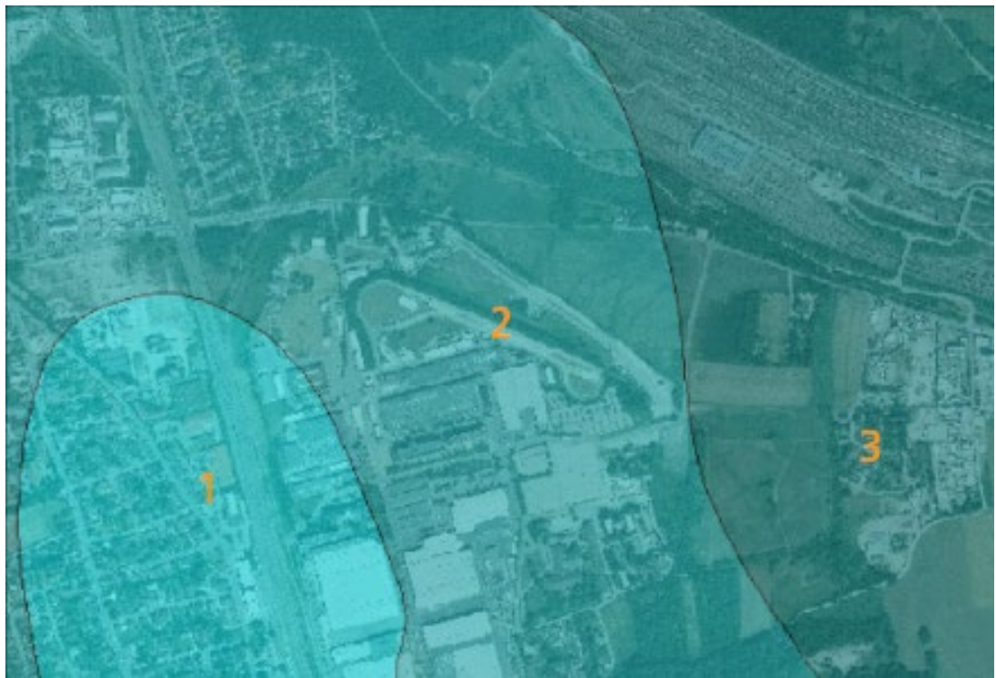
Abbildung 10. Grundwasserflurabstandsklassen (1 von 6-8 m, 2 von 4-6 m, 3 von 2-4 m [44].
